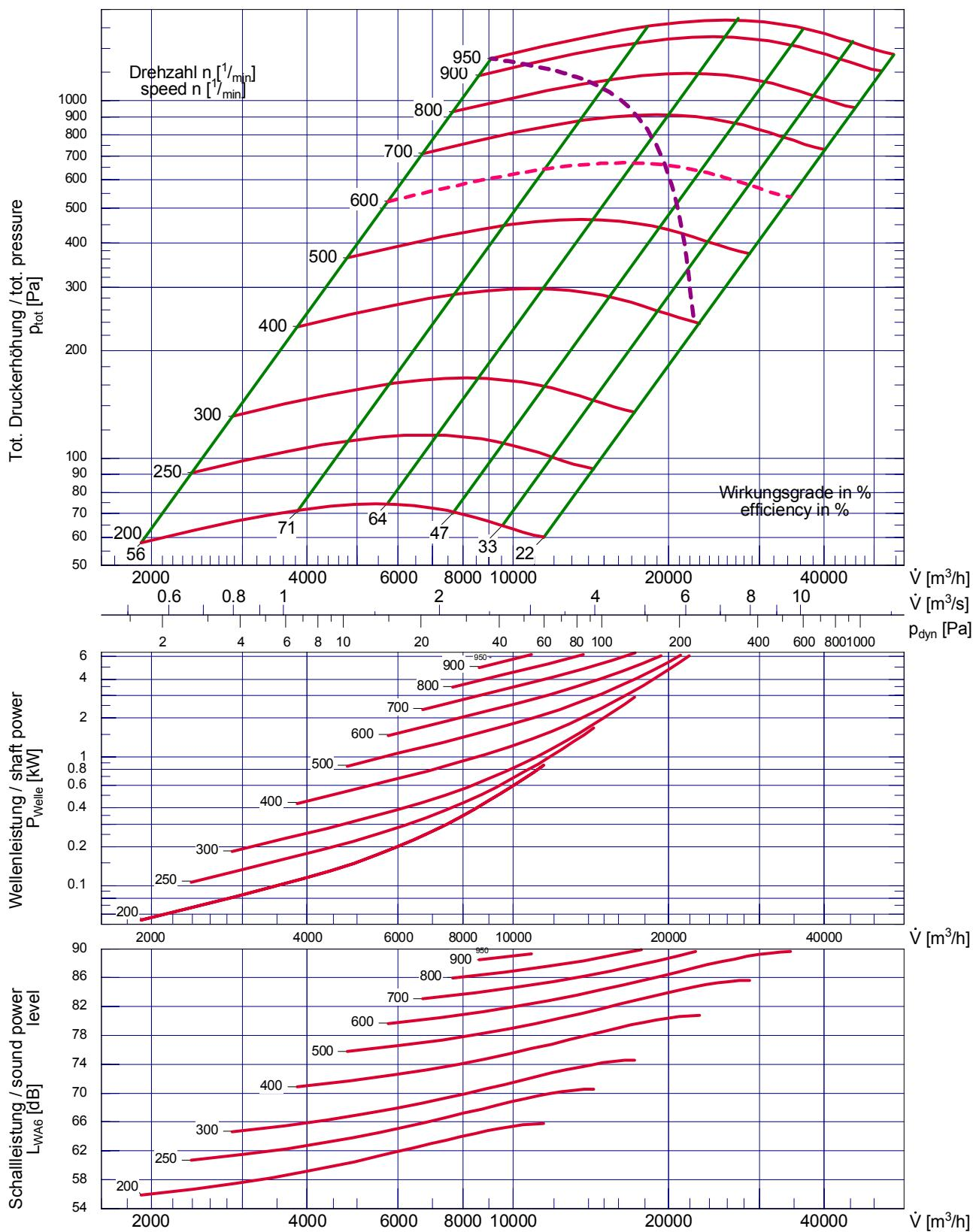
Laufraddurchmesser / impeller diameter
