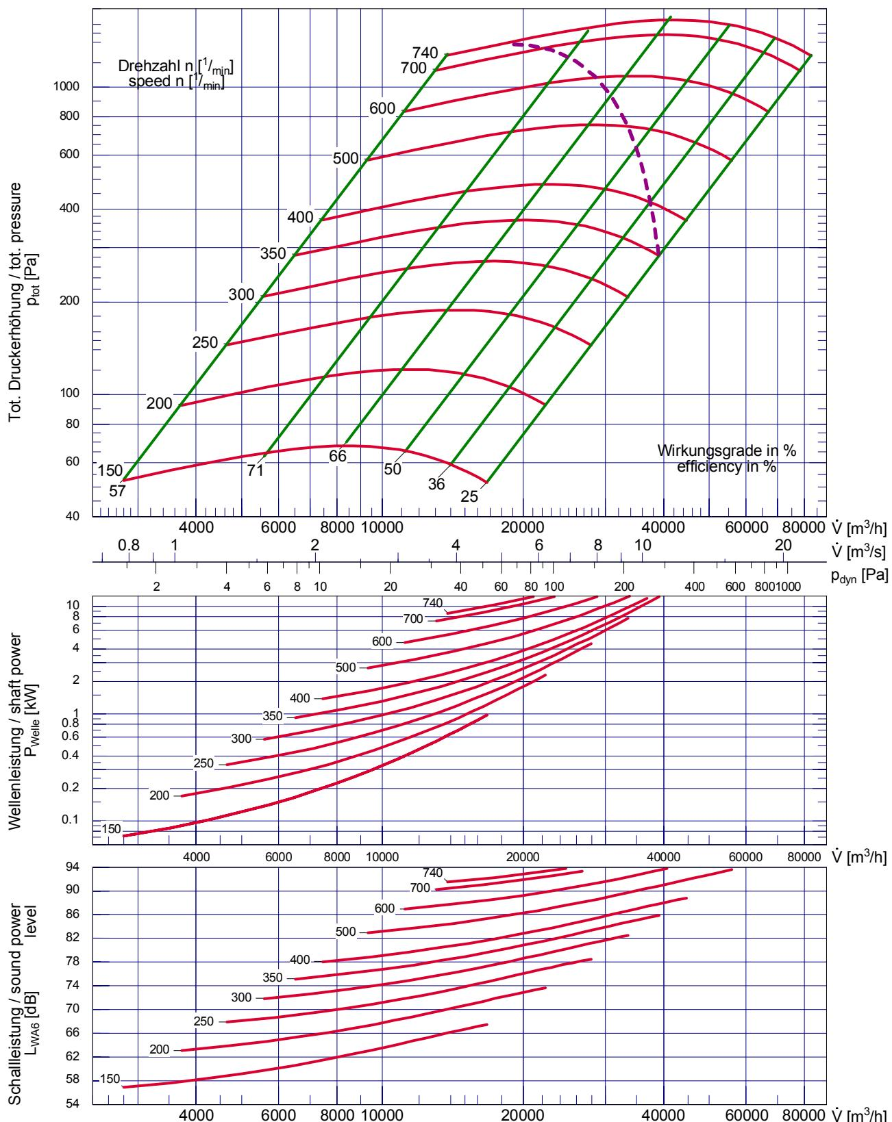
Lauftraddurchmesser / impeller diameter
