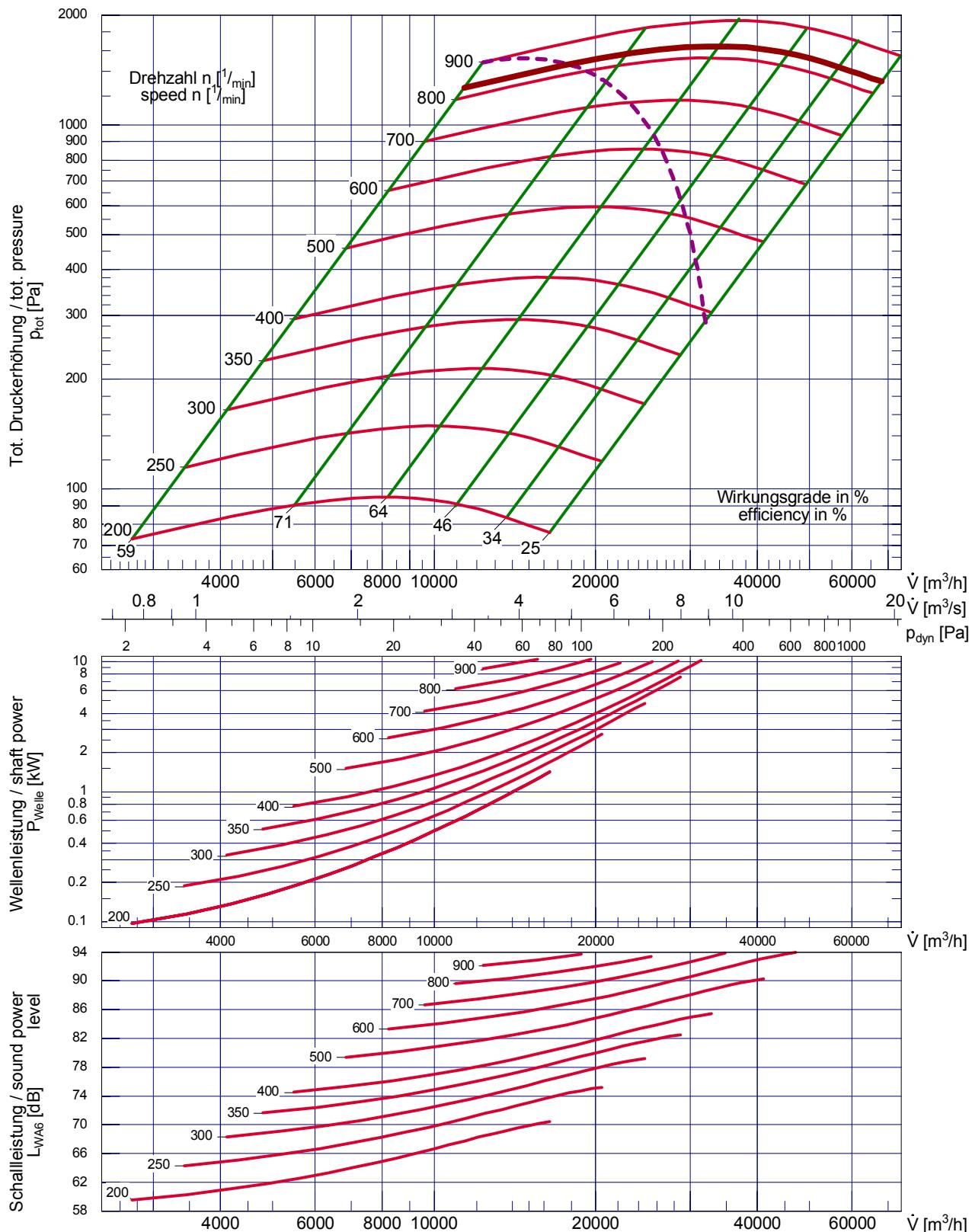
Lauftraddurchmesser / impeller diameter
