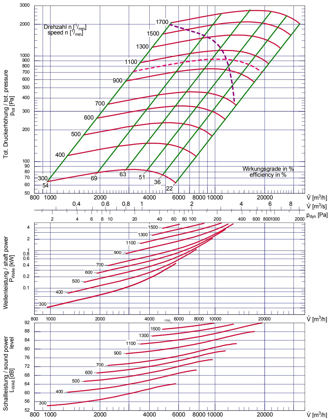
Laufraddurchmesser / impeller diameter
