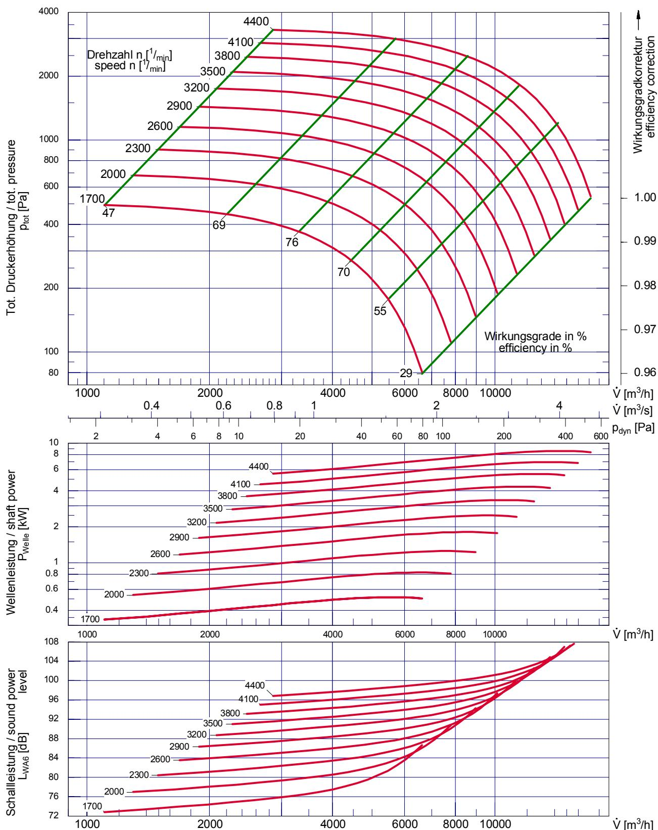
Laufgraddurchmesser / impeller diameter
