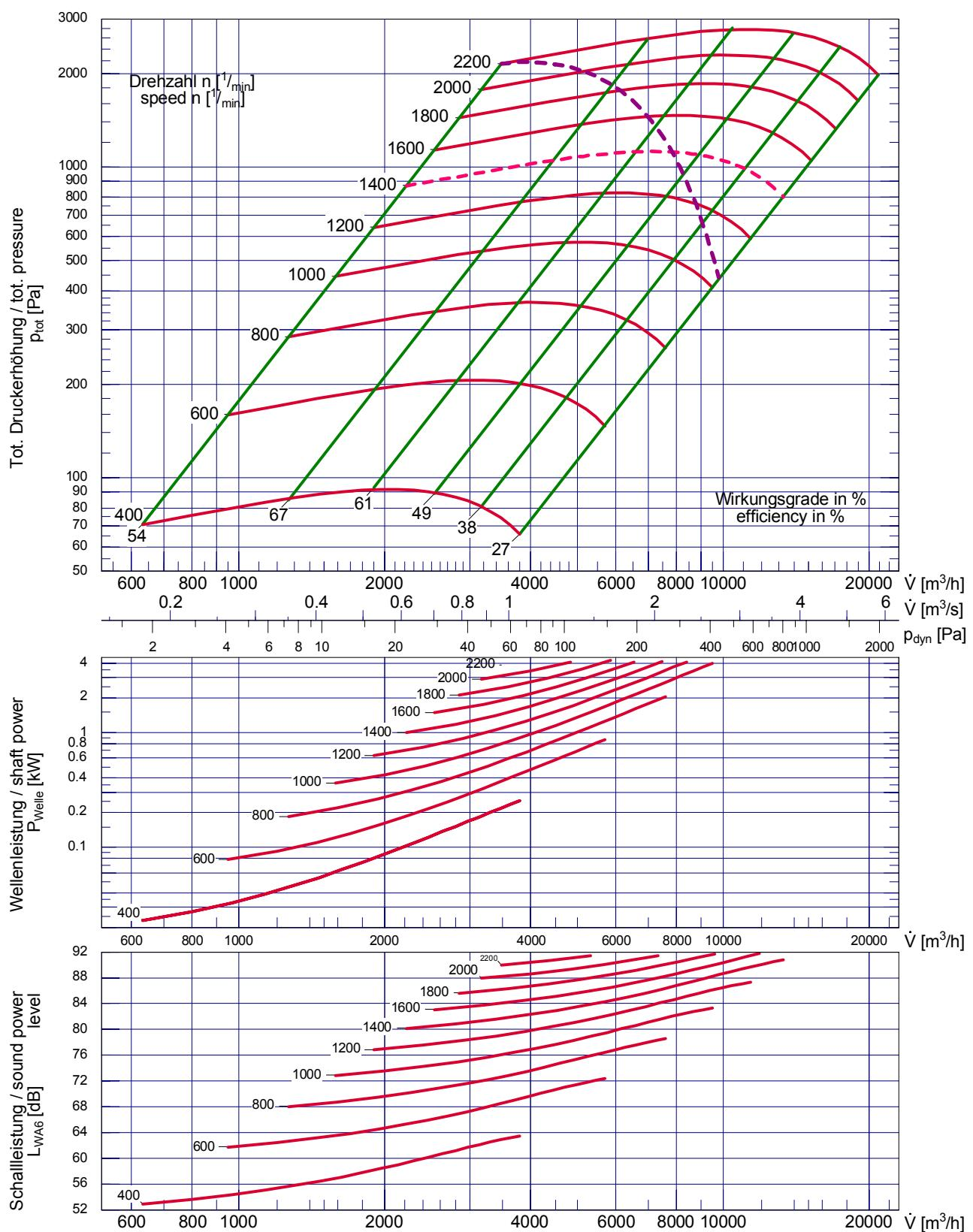
Laufraddurchmesser / impeller diameter
