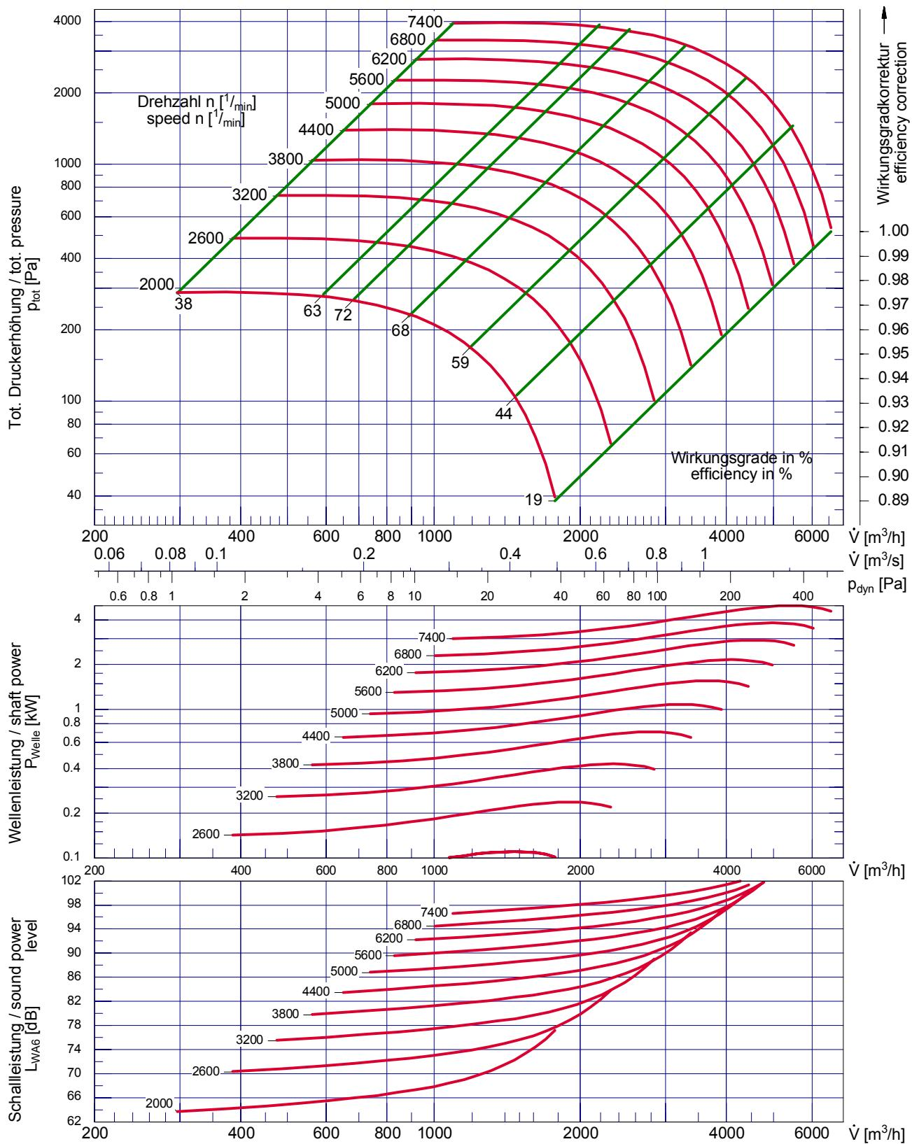
Laufraddurchmesser / impeller diameter
