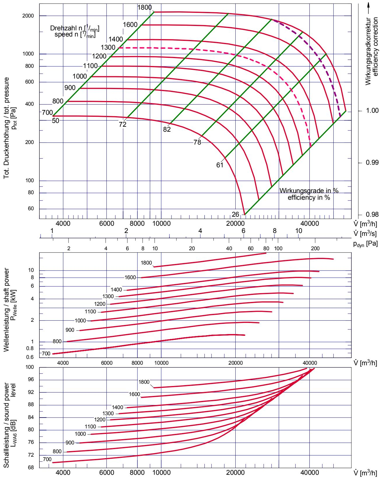
Laufraaddurchmesser / impeller diameter
