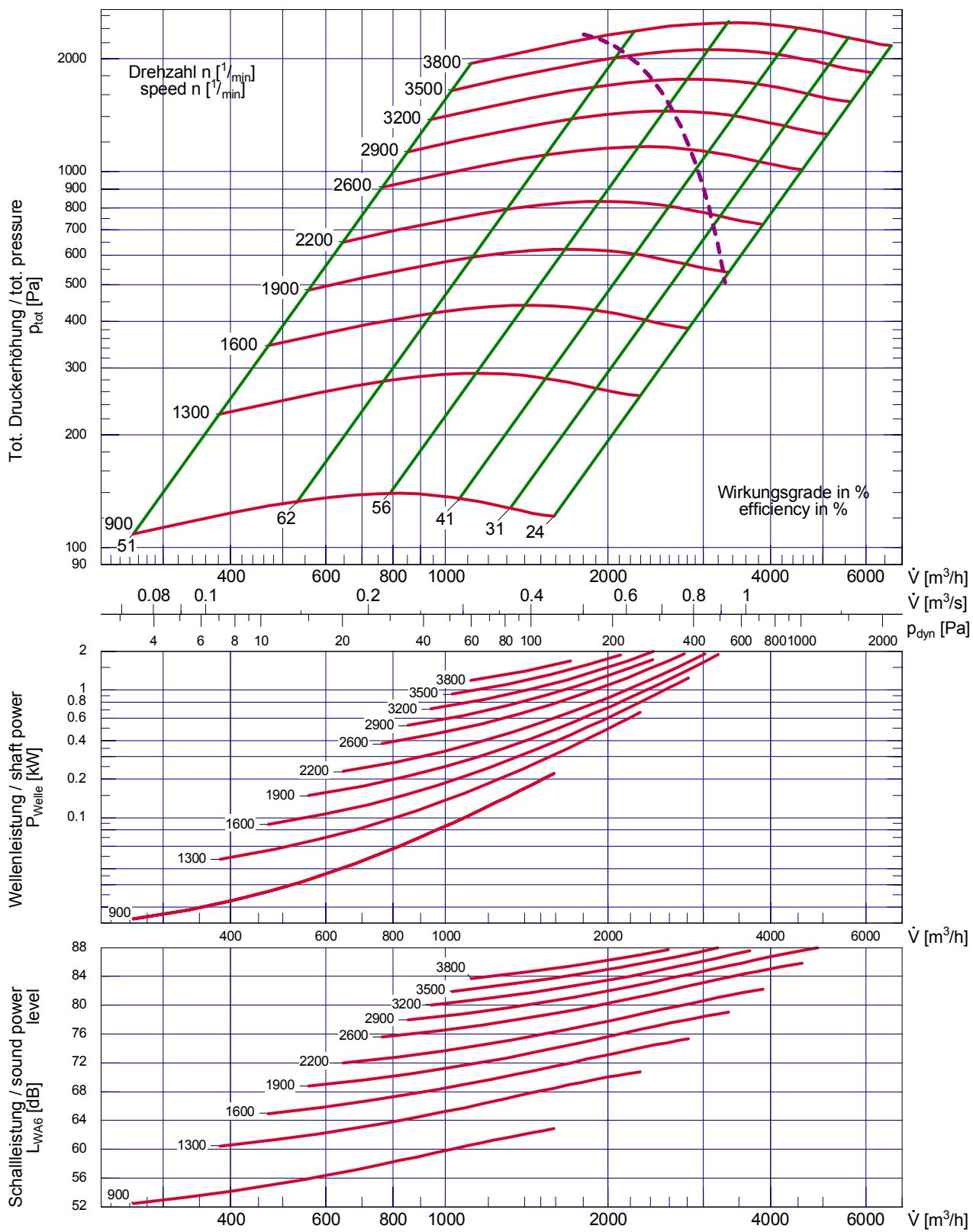
Laufaddurchmesser / impeller diameter
