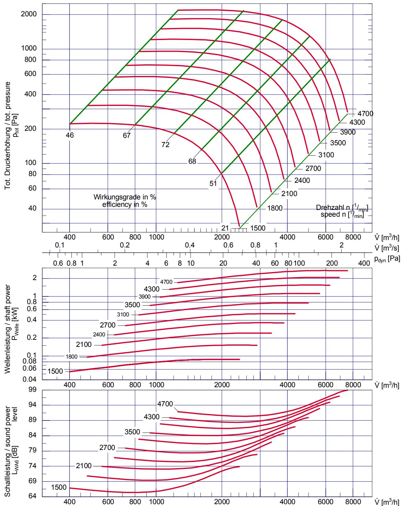
Laufraddurchmesser / impeller diameter
