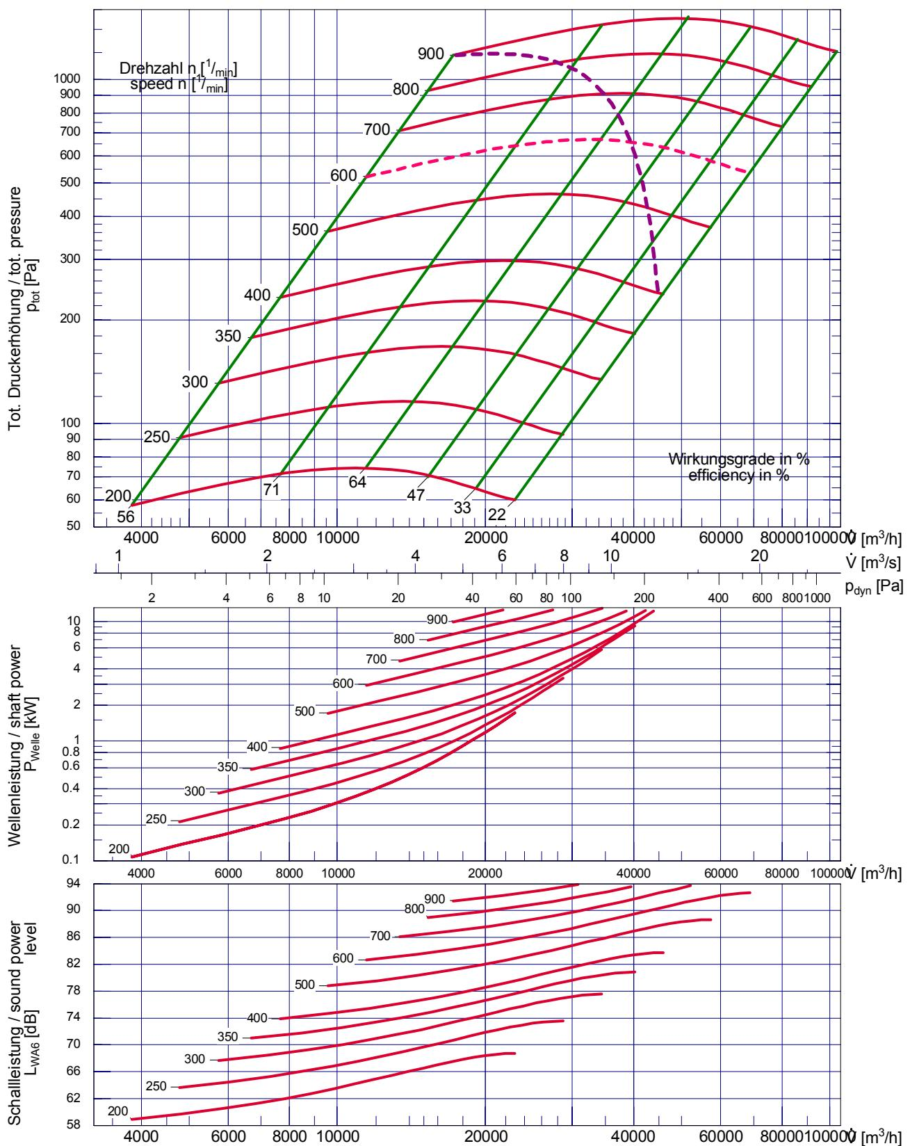
Laufraddurchmesser / impeller diameter
