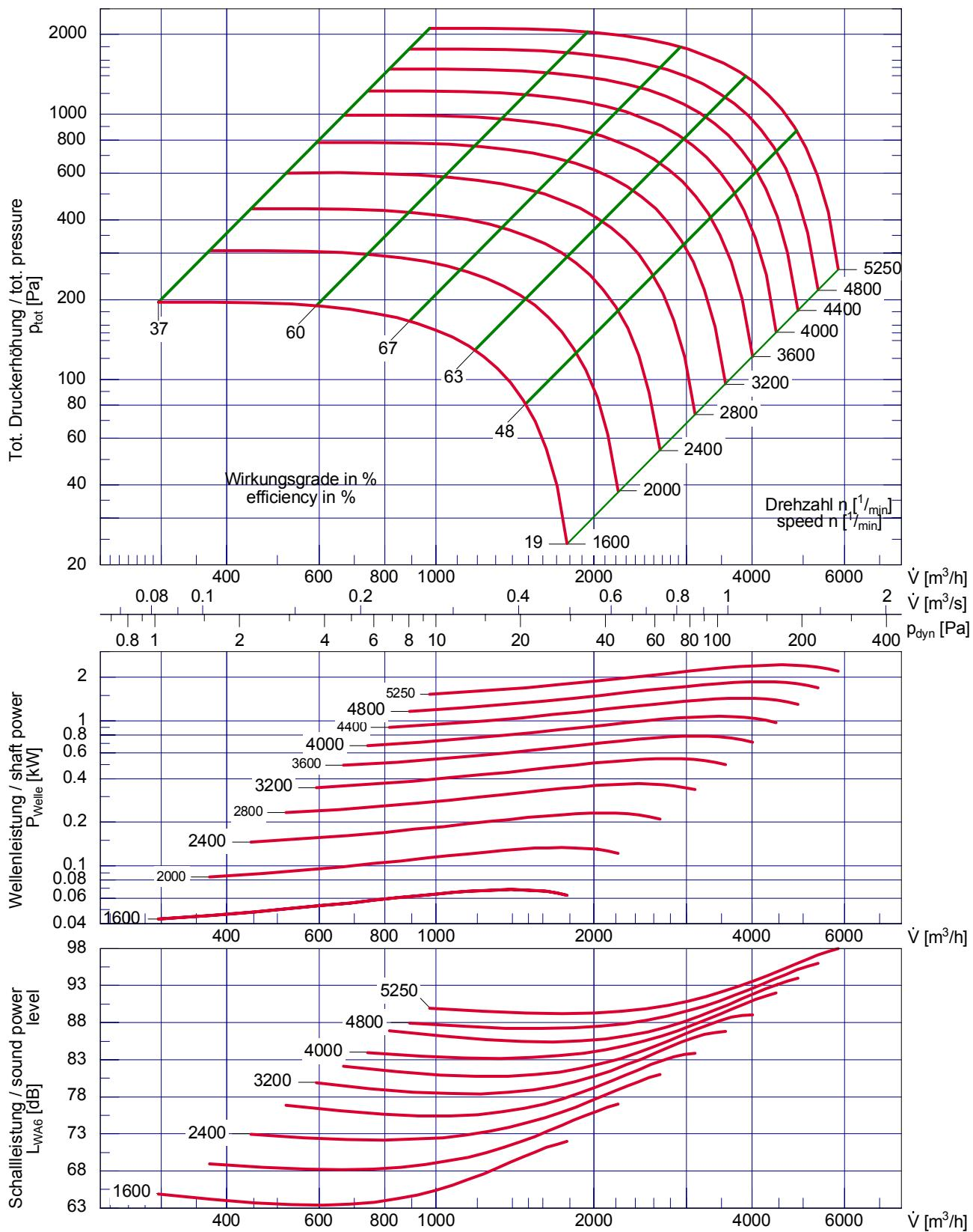
Laufraddurchmesser / impeller diameter
