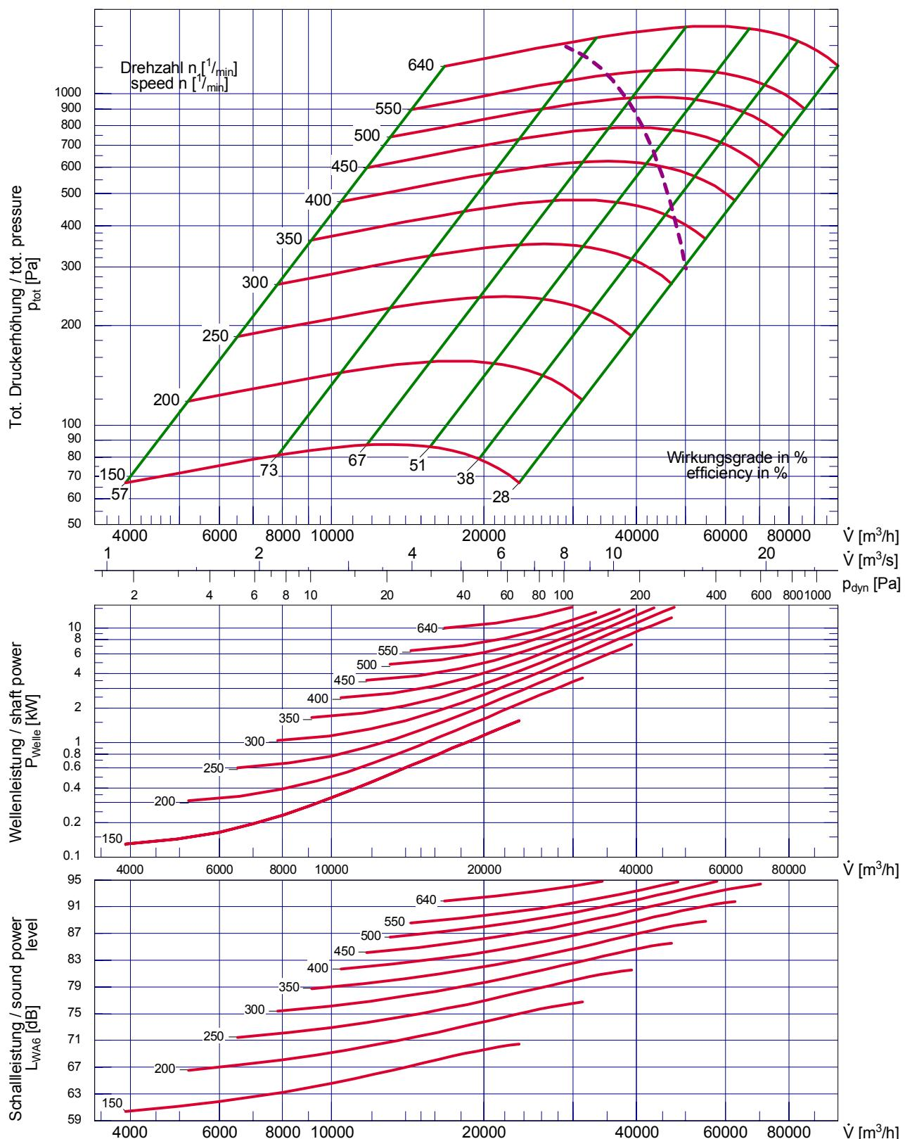
Laufraddurchmesser / impeller diameter
