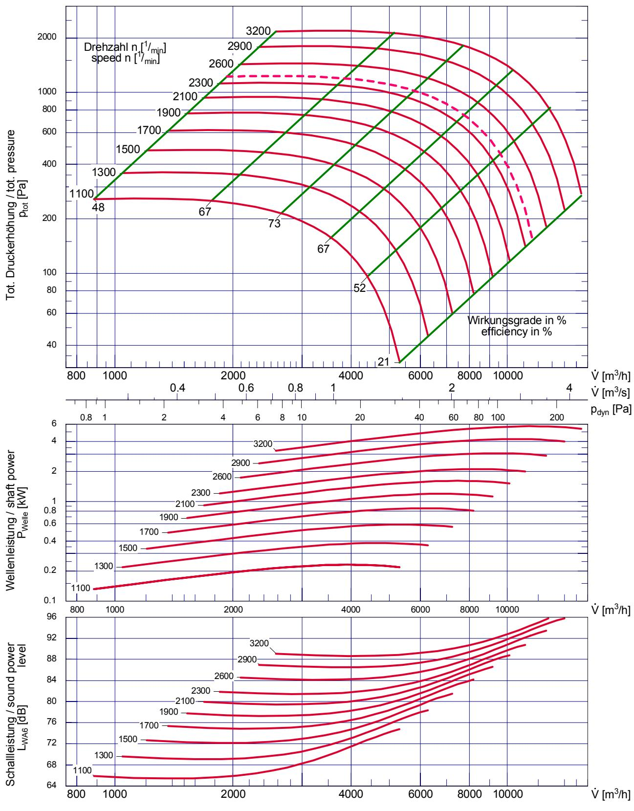
Laufgraddurchmesser / impeller diameter
