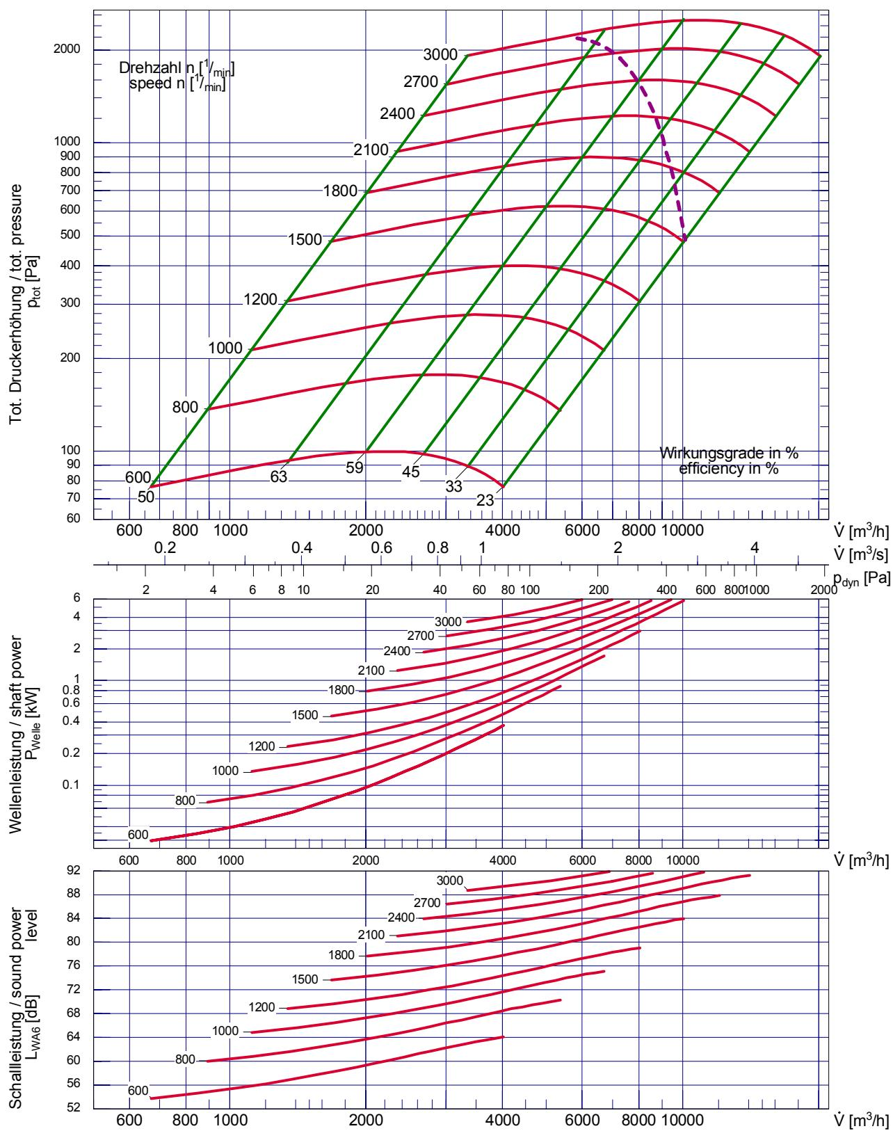
Laufraddurchmesser / impeller diameter
