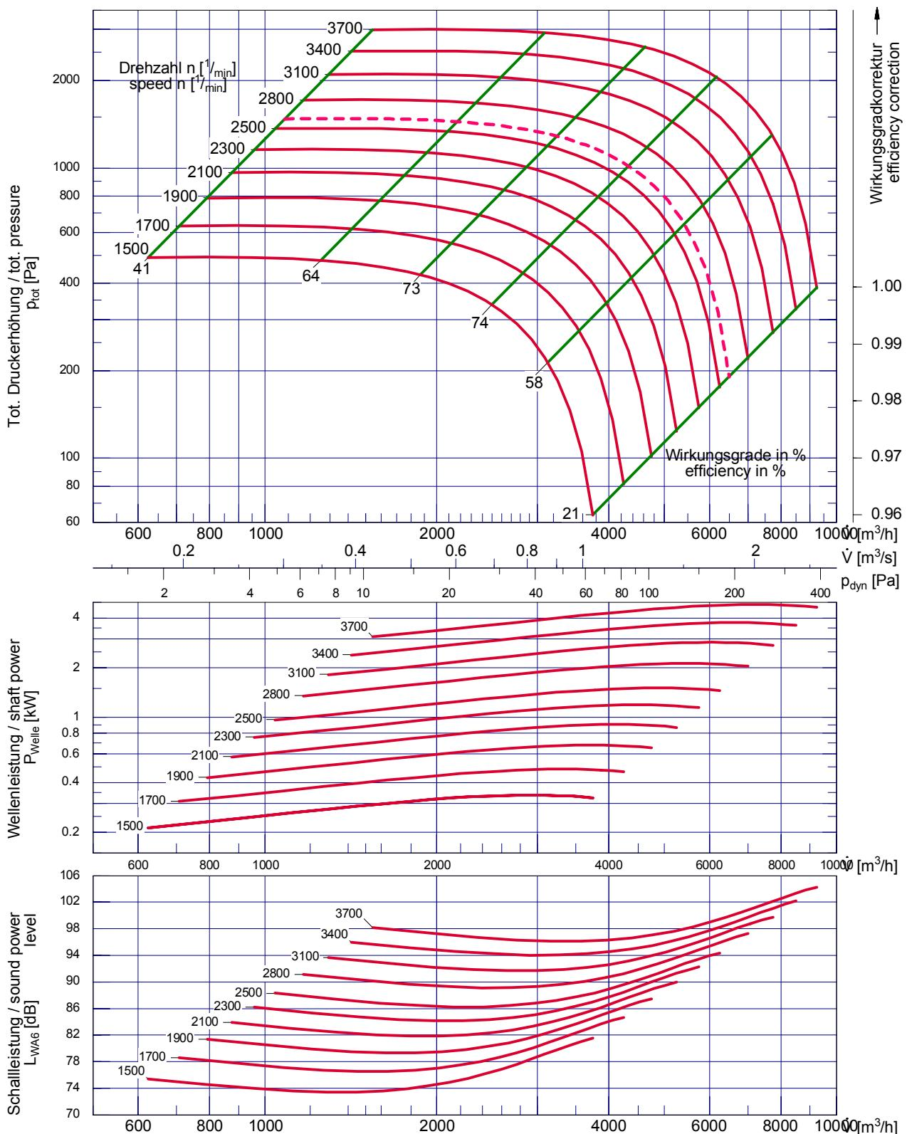
Laufraddurchmesser / impeller diameter
