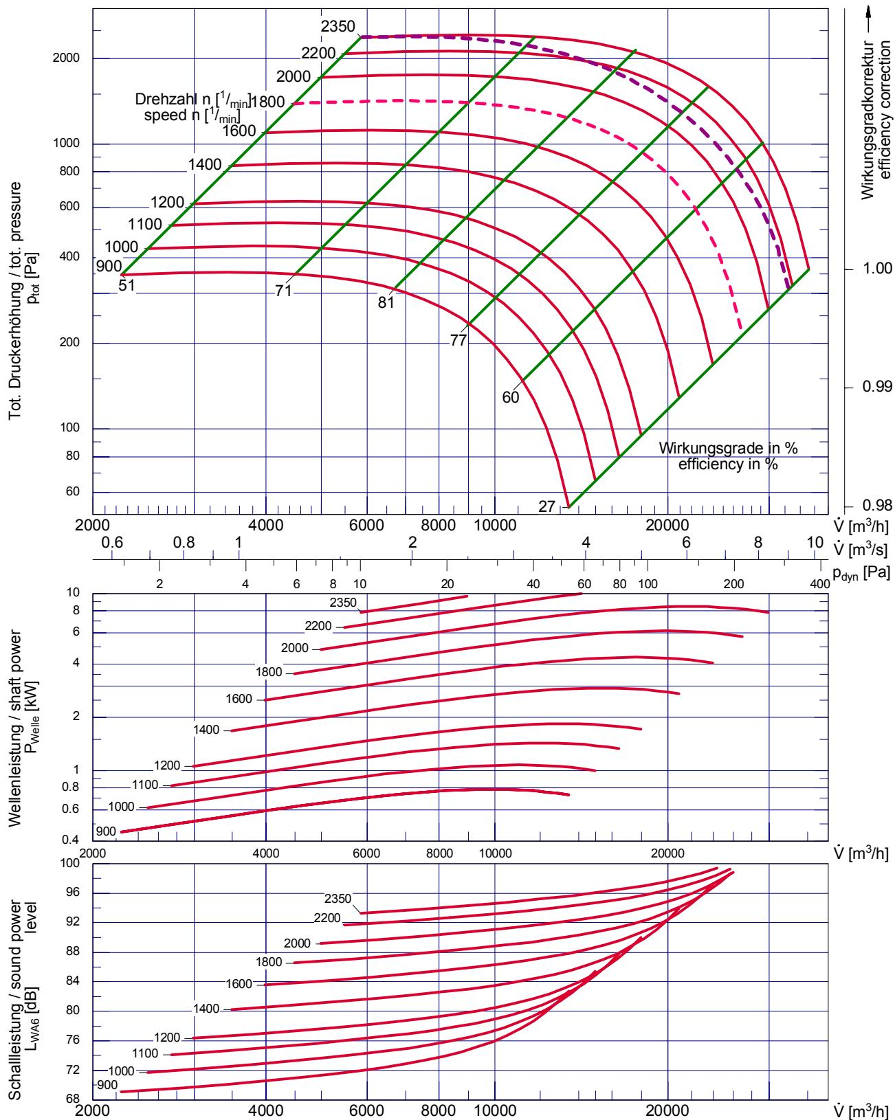
Laufraddurchmesser / impeller diameter
