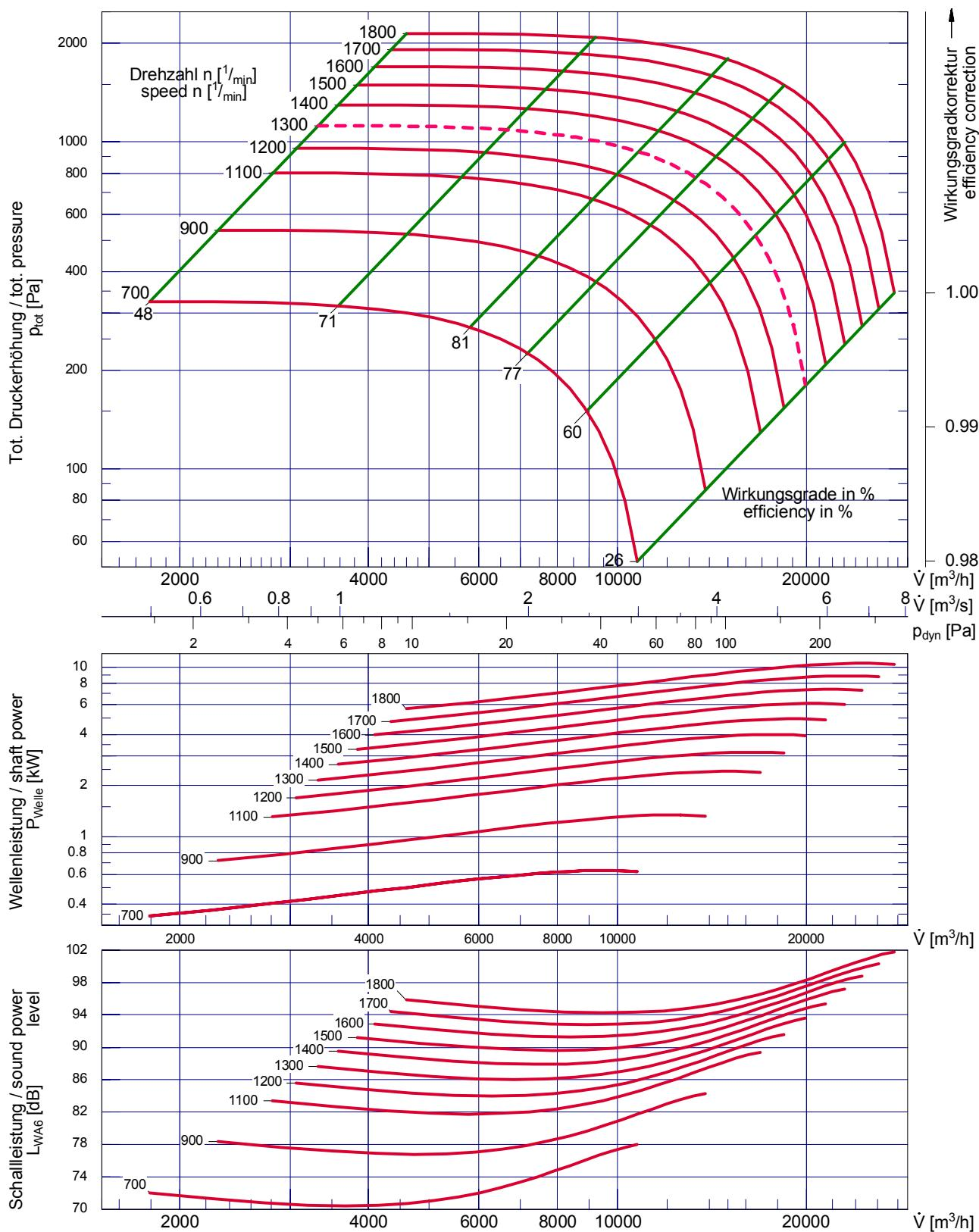
Laufraddurchmesser / impeller diameter
