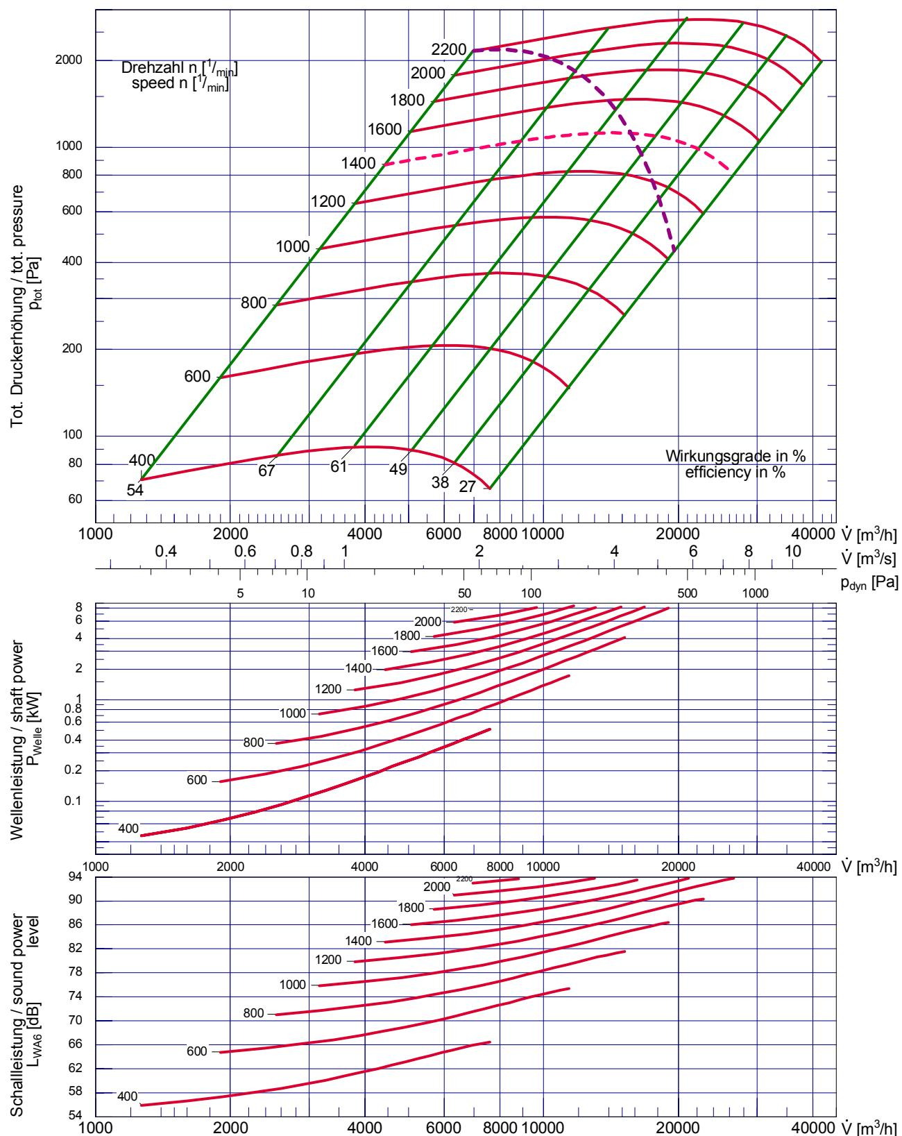
Lauftraddurchmesser / impeller diameter
