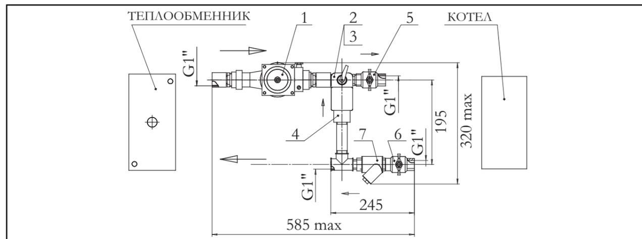
1 – циркуляционный насос, 2 – трехходовой клапан, 3 – электропривод, 4 – клапан обратный,
