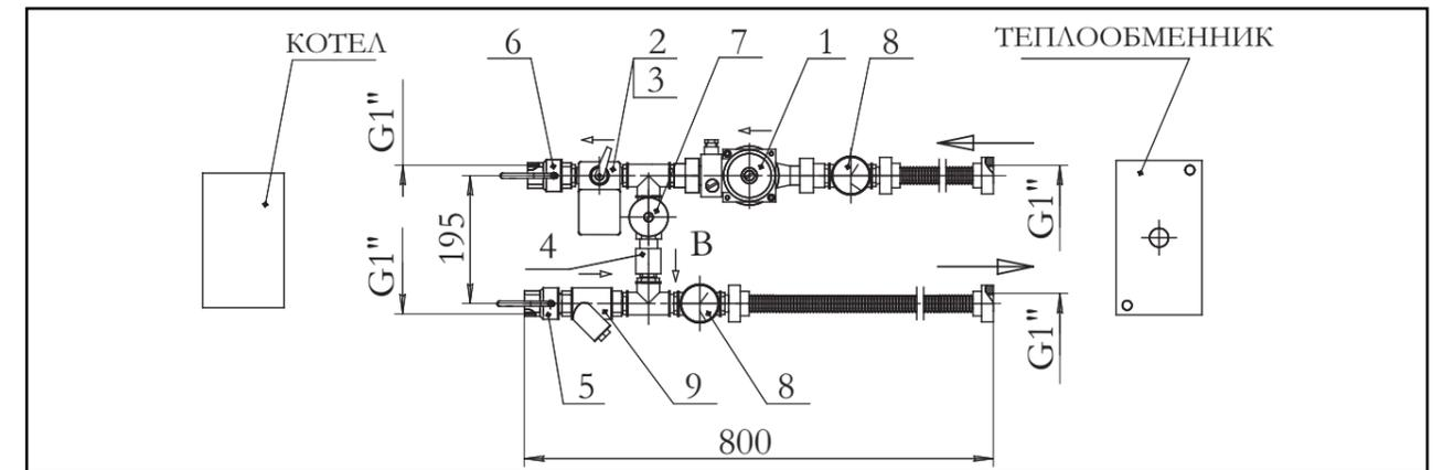
1 – циркуляционный насос; 2 – двухходовой регулирующий шаровый клапан; 3 – электропривод; 4 – клапан обратный; 5, 6 – шаровые краны; 7 – регулирующий вентиль; 8 – термоманометры; 9 – фильтр
