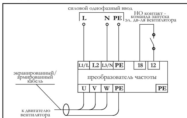
Для описанного способа регулирования может успешно применяться частотный преобразователь Danfoss VLT Micro Drive FC-051 – имеющий векторную и скалярную системы управления двигателем. Преобразователь превосходно подходит также для комплексной автоматизации системы.
