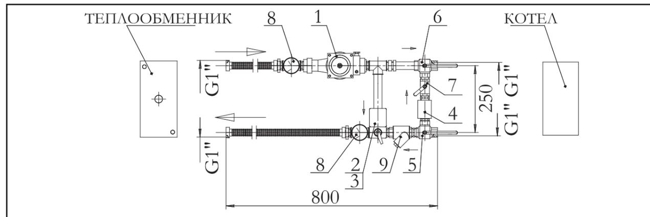
1 – циркуляционный насос; 2 – трехходовой регулирующий шаровой клапан; 3 – электропривод;
