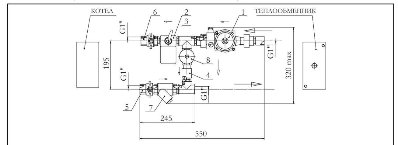
1 – циркуляционный насос, 2 – двухходовой клапан, 3 – электропривод, 4 – клапан обратный, 5, 6 – краны шаровые, 7 – фильтр, 8 – регулирующий ручной кран
